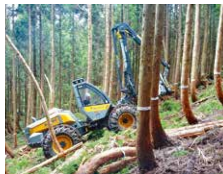
先進的ハーベスタ 伐木から造材（丸太づくり）、集積（積み置き）まで1台で行える多工程機械
