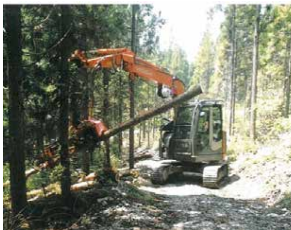
写真4 高性能林業機械による造材作業 (大分県佐伯市)
