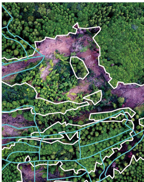
写真2 ドローンによる空中写真を活用した損害調査 (白色の線:損害区域 水色の線:林小班界)
