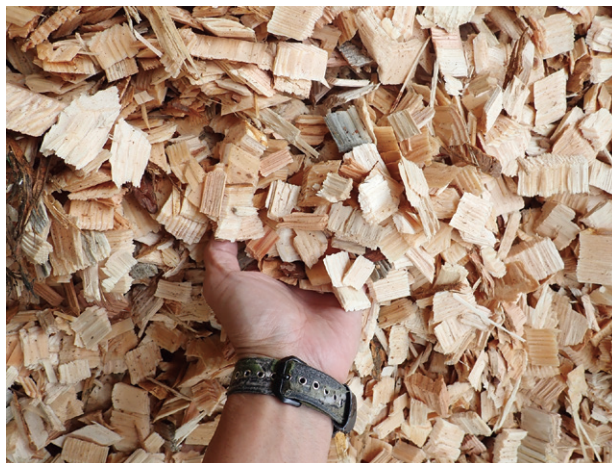
写真2 燃料利用のためチップ化されたアカマツ被害材 腐朽により変色した木片が混ざっているが、燃料としての利用に問題はない。
