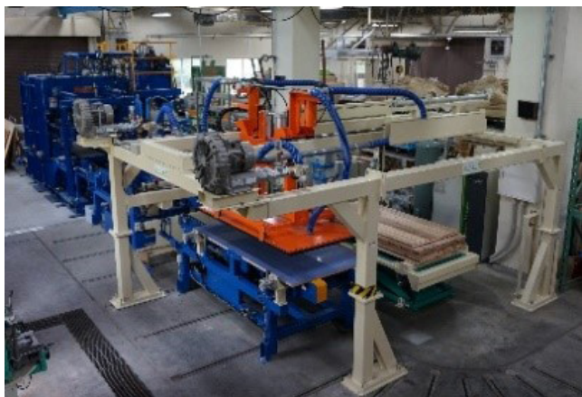
CLT( 直交集成板 ) の製造実証装置
