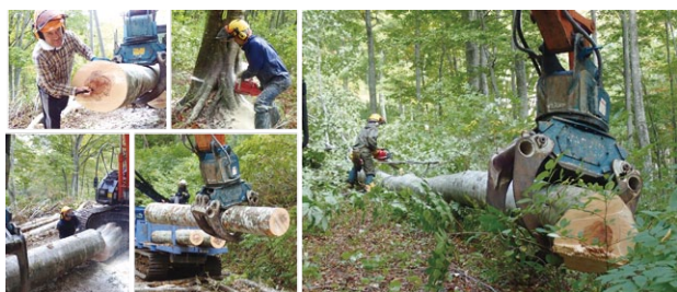
写真－4 高度な伐倒技術と利用目的に応じた適切な採材はグラップルとの連携が必要
