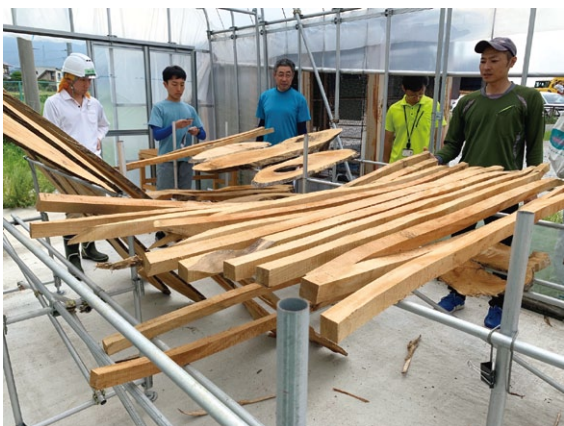
写真－３ 小径木を粗挽きし、温室で一次乾燥。滋賀県東近江市永源寺森林組合
