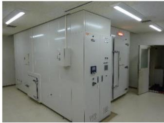
木質耐震・快適性工学実験棟のビルドインチャンバー（生活の場に存在する木材及び木質空間が人間の健康、情緒に与える効果を科学的に解明するために、温湿度、照度等の環境を精密に制御できる人工気候室）が老朽化により温湿度等の制御に不具合を生じていたことから、より生活空間に近い実験環境を再現できる最新式のものに更新。
