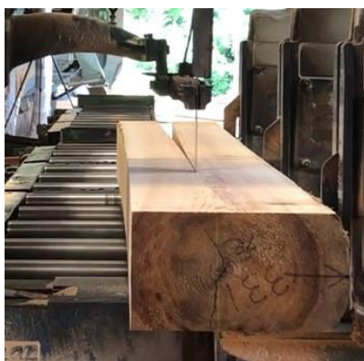
製材時に発生する心去り平角の反り 切断すると左右に開くように反ってしまう
