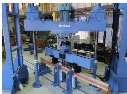
実物大建築部材の性能評価
