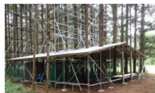
降雨遮断による土壌乾燥実験
