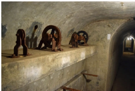
地下道に現在も残る積雪移動量記録装置の滑車
