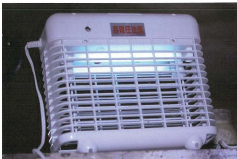
写真-39 電撃殺虫器
