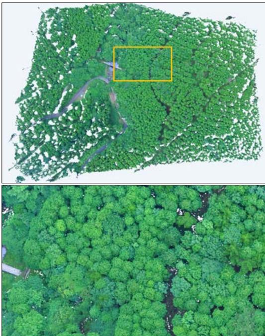
写真5-1 ドローンで撮影した96枚の画像から作成したオルソモザイク空中写真（約5ha）（上）と橙色の枠内の拡大写真（下）。解像度は約4cmで、ヒノキ林の中に広葉樹が混在している様子なども確認できる。
