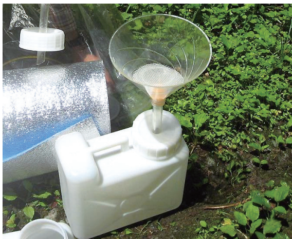
写真-1 雨水の採取装置
