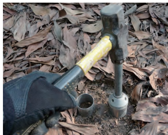
写真3 土壌サンプリングの様子 土壌円筒をハンマーで貫入させて 採取する。
