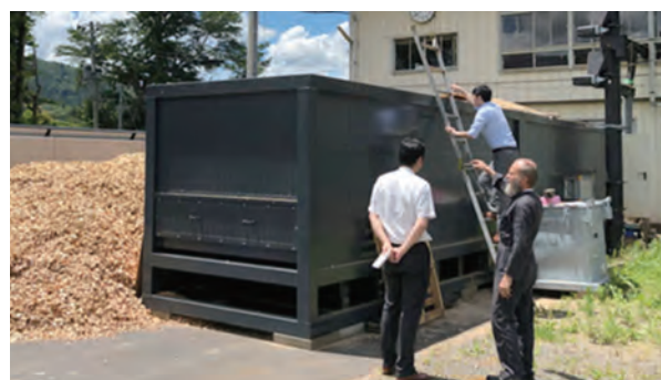
写真3 小型ガス化 CHP 装置に取り付けられている燃料チップ乾燥コンテナ
