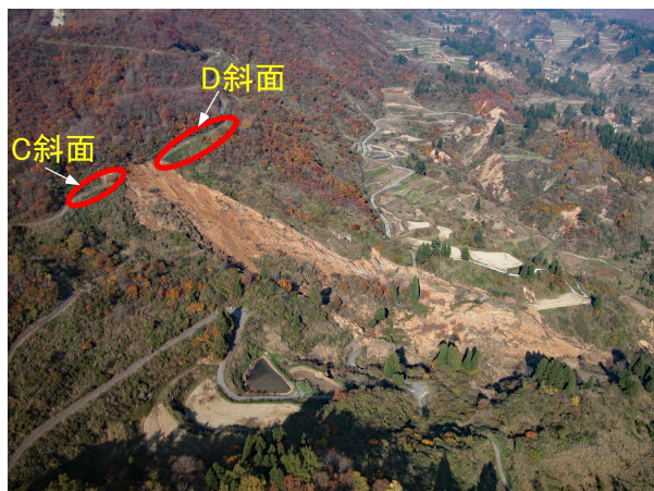
写真－4 中越地震時の斜面崩壊 （写真提供、落合博貴）
