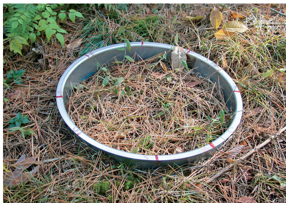
写真-1 ガス発生・吸収速度観測用 チャンバー
