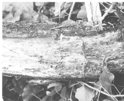
写真－2 林内放置丸太のシロアリ被害痕
