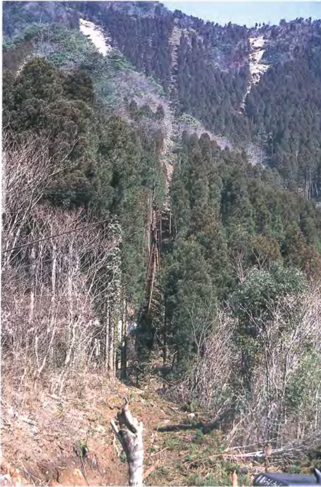
写真-2 山の稜線近くから土場まで張られた1スパン700mの架線を伝って、枝葉が付けられたまま降ろされてくる林木
