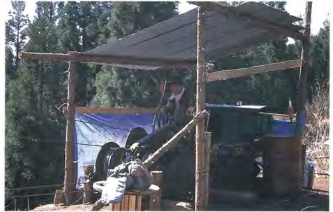
写真-1 土場で架線集材機を操るオペレータ
