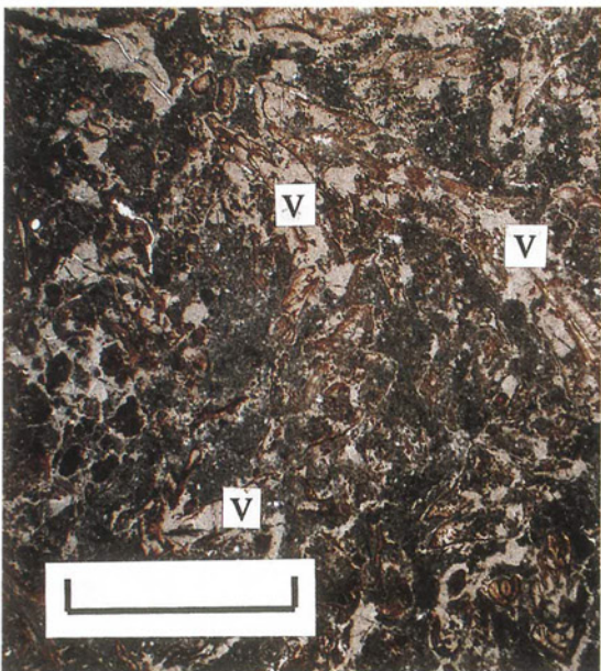
写真-2 ヒノキリター堆積地における水平断面の土壌薄片（スケールは1cm, vは孔隙） 5mm
