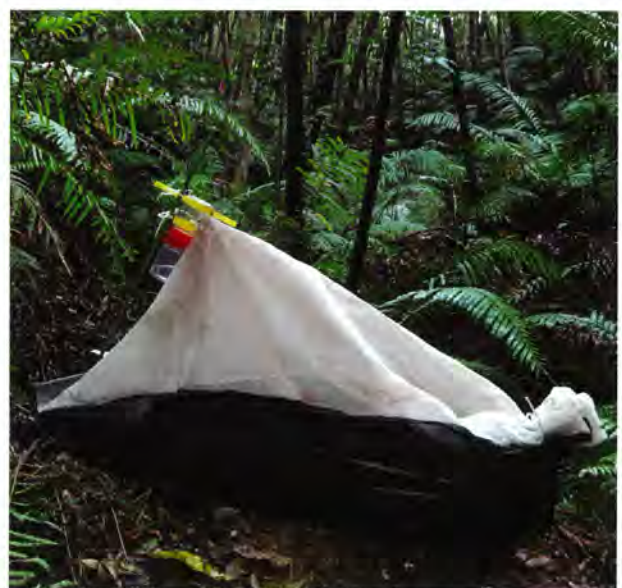
図-1 倒木利用昆虫の採集に用いたトラップ テント型の網の中に材が入っている。材から発生した昆虫は、防腐剤の入った、トラップ頂端のプラスチック製の瓶の中に落下する。
