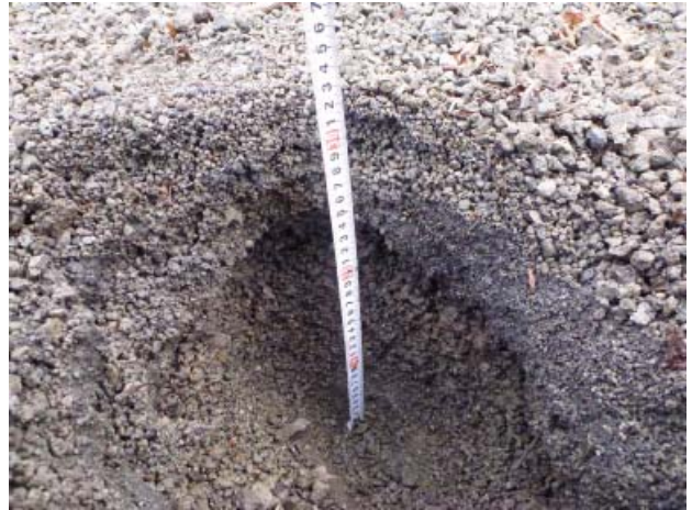
図－1 斜面における軽石と火山灰の混合層
