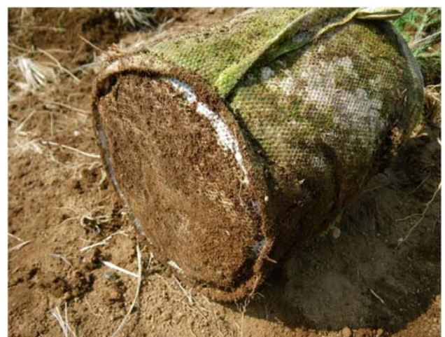
図—1 ポリ乳酸性不織布による生分解性ポット
