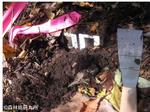
写真-1 試験地内に設置したイオン交換膜の掘り取り
