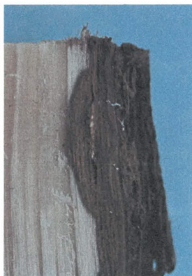
写真-4 皮紋の断面。 内樹皮を越えて、形成層に 達している。(以上吉田原図)
