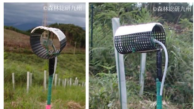
図-2 センサーへの直射日光を防ぐ自作シールド (撮影は別の試験地)
