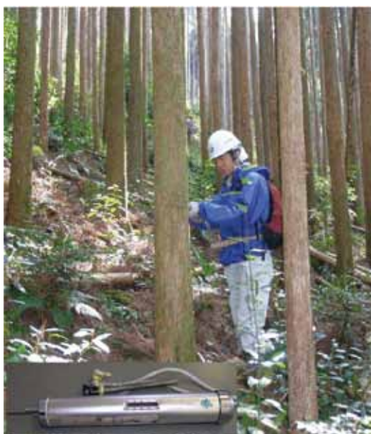
ピロディンを用いた容積密度の非破壊測定
