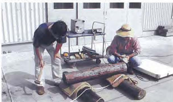
図1. タッピング法によるスギのヤング率測定の様子
