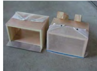
写真1 土砂受け箱の前（左、斜面に設置）と後ろ（右）
