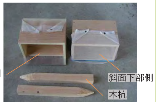
写真2 ばらした状態の土砂受け箱
