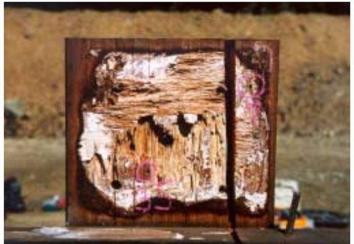
写真3 トラス柱材の上弦材との接合部界面
