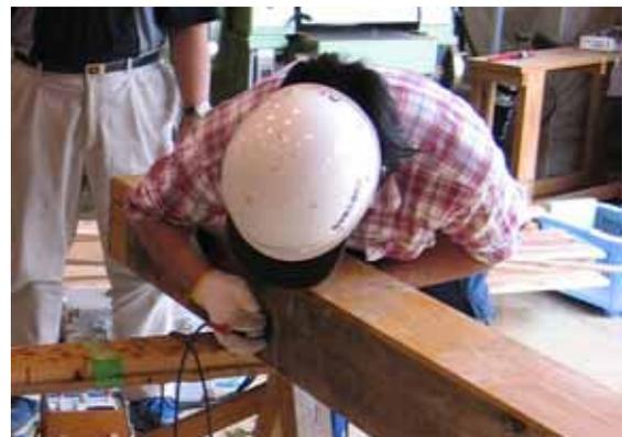
写真 - 4 超音波伝播速度の測定方法
