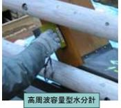
電気抵抗式含水率計                      高周波容量型水分計
