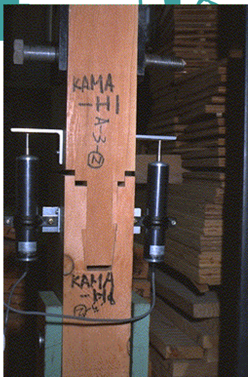
Tensile test of Pre-cut KAMA joint プレカット鎌継手の引張試験
