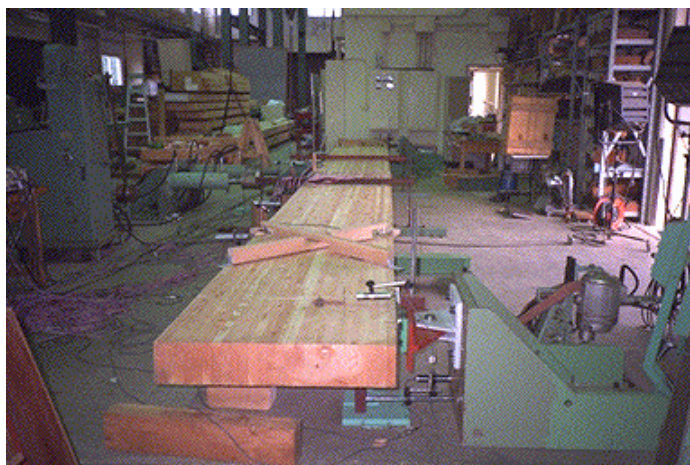
4 point bending test on Douglas-Fir glulam beam (Depth :91 cm) 梁成 91 cm のダグラスファー集成梁の 4 点曲げ試験
