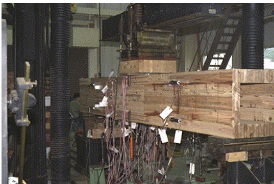
3 point bending test of Box G.L.T. Beam 集成材箱型断面の3点曲げ試験
