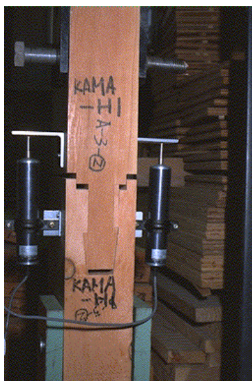
Tensile test of Pre-cut joint プレカット鎌継手の引張試験
