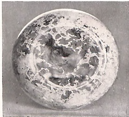
腐敗に依り供試料バルブを白色に變色せし狀況
