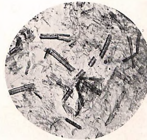
セルローズ溶解菌に依り腐敗しバルブ纖維は寸斷せられたる狀況
