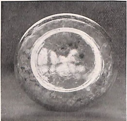
腐敗に依り供試料バルブを白色に變じ黒褐色の斑紋を點在する狀況
