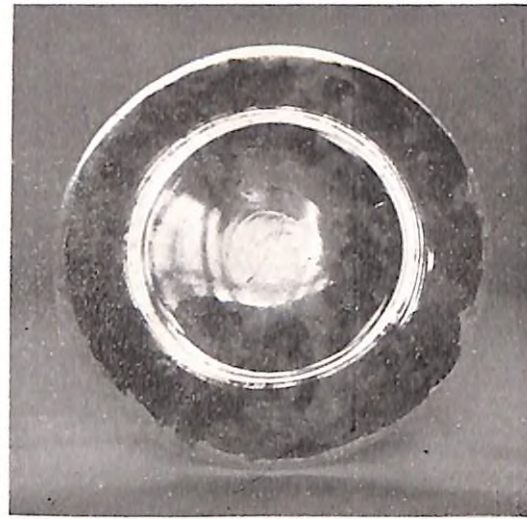
腐敗に依り供試料バルブを黒褐色斑紋狀に變色せし狀況
