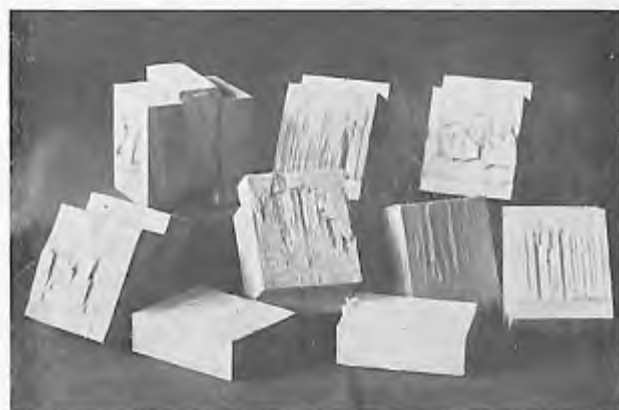
上段 グルー接着によるもの 下段 膠接着によるもの
