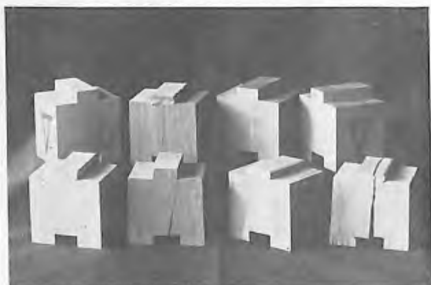
(第 11 圖) 比較試験材の破壊状態
