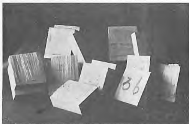
上段 膠接着によるもの 下段 グルー接着によるもの
