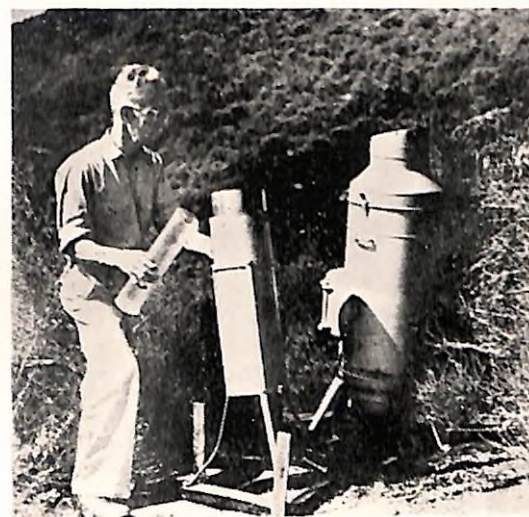
PL.1 左は、アメリカ気象局標準型8吋口径雨量計を斜面に直角に傾斜させたもの。右は、受水面を斜に切った Fergusson の自記雨量計。
