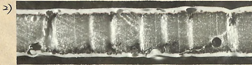
写真3. 原木Iの切削割れ(無処理材)
