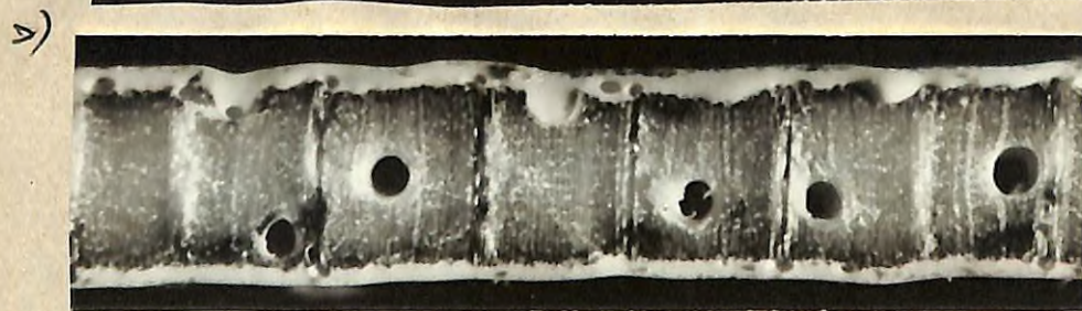
写真4. 処理材(60℃~24hr)の切削割れ(原木II)
