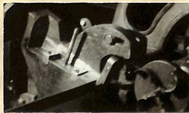
写真1. ブレッシヤバー（ノーズバー）引上角度変換用コマ
