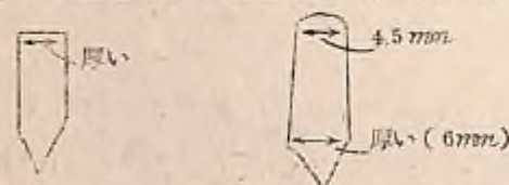
改良前のナタの断面 改良後のナタの断面
