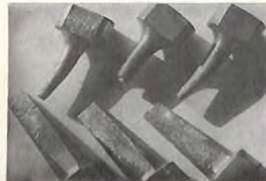
同上ピョタアップ取付用岩固定ハーネン
