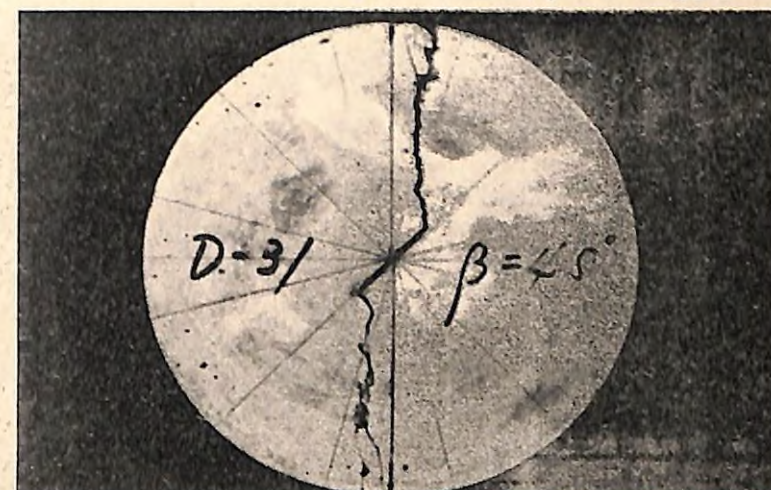
図-39 コンクリート円板の破壊様相 ( \beta = 45^\circ の場合 )
