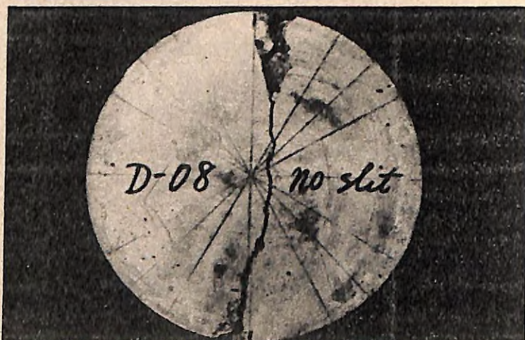
図-43 無スリットコンクリート円板の破壊様相
