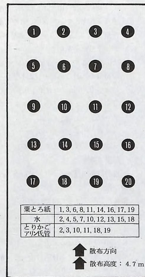
図-1 落下量調査3紙、粟、水および鳥カゴ、アリン氏管の設定位置
