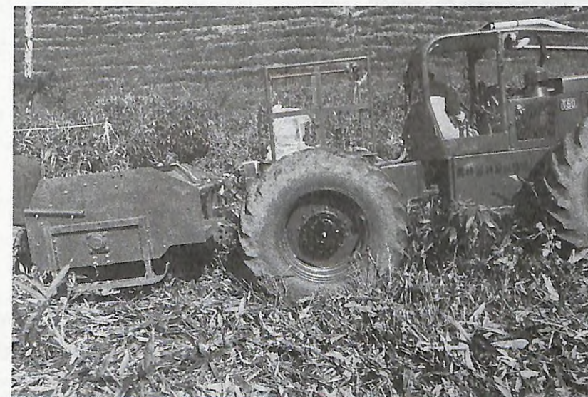
写真-1 T-50形ホイールトラクタに装着した試験装置
