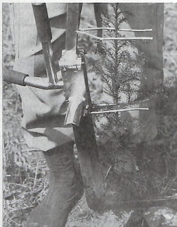
写真-6 L形植付け爪と挟持挿入装置（スギ苗）
