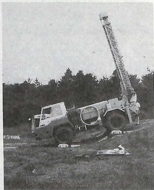
写真-16 重心の高さの算出に必要な事項の計測(傾斜角14°30')
