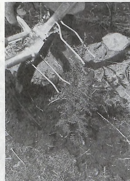
写真-7 L形植付け爪により挿入・垂直位置に放置して引抜くところ
