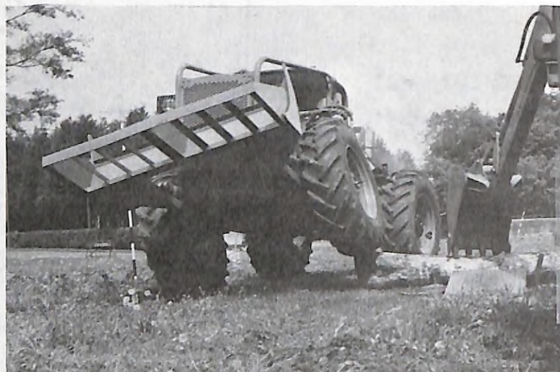
写真1. 丸太乗越え実験
