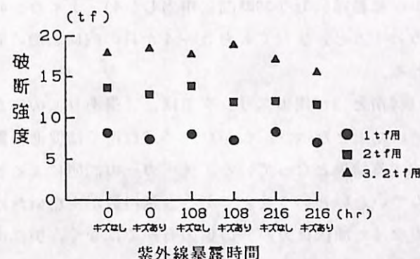
図23. 合成繊維スリングストレート引き破断強度（ピン径40mm）
