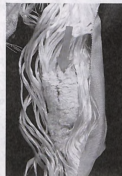
図25. 内部繊維の切断状況
