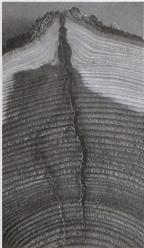
写真4. 開閉している凍裂部
