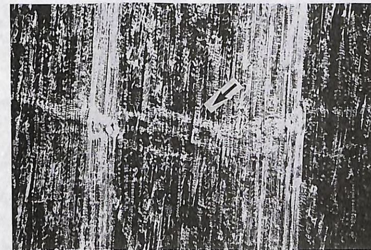
写真12. 偏光顕微鏡による破壊線の検出(矢印)
