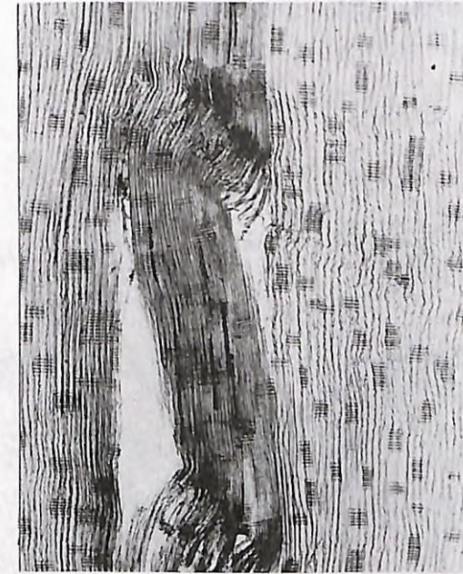
写真10. 晩材部での開裂
