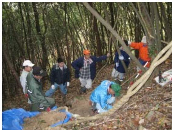
堆積有機物調査と土壌炭素蓄積量調査の実習を行った。未経験者を中心に断面記載と試料の採取を行い、経験者が有機物の区分や円筒試料採取のコツなどをアドバイスする形で実習は進められた。両調査終了後に二地点の比較を行い、尾根寄りの S より、谷に近い E で A 層が厚く土色の黒みが強いことを確認して、初日の講習を終了した。
