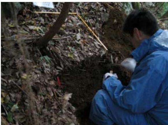
を中心に代表断面の記載を行った。局所地形については、斜面の頂上が確認できないことから、山腹凸型斜面（浸食面）であるとの説明を行ったが、局所地形の判定が難しいとの意見が出され、図入りのマニュアルを整備する必要性を実感した。代表断面の土壌型は、土壌が乾燥し、A 層の土層が比較的薄くまた土色が淡く、粒状構造および菌糸が認められたことから B<sub>B</sub> 型と判定
