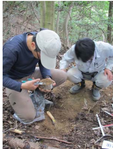
⑤円筒による土壌採取。剪定鋏の向き、レキと根の処理に注意して、表面が凸凹にならないよう整形中。
