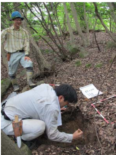
③粗彫りの後、断面を整形する際は、基本的に、堆積有機物層は剪定鋏で、鈎質土壌はコテを用いて整形することを説明。
