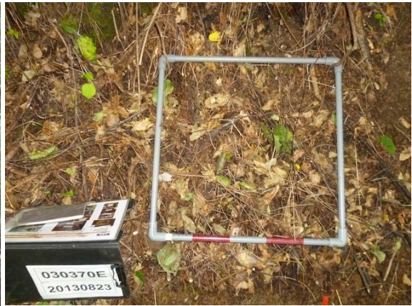
宮城環境保全研究所では、堆積有機物採取用に塩ビパイプで自作した専用の方形枠を使っていた。
